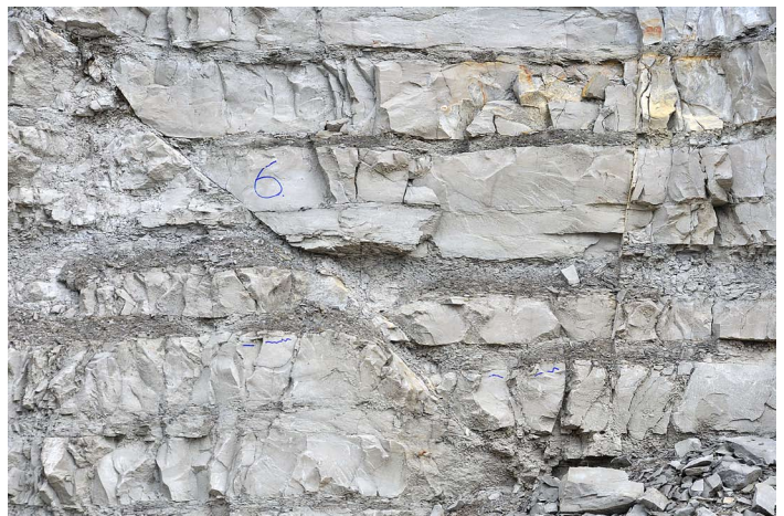
Abb. 12: Detailansicht einer Kleinabschiebung (Messpunkt s6 in Diagramm Abb. 13). Am Versatz der doppelten Mergellage lässt sich der Verschiebungsbetrag (weniger als 10 cm) gut erkennen.
