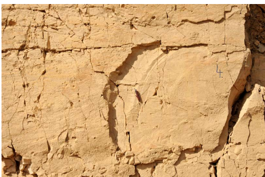
Abb. 7a/7b: Kluftentwicklung am Messpunkt 4 (Maßstab: Taschenmesser in Bildmitte). Die als Besenstrukturen (Eisbacher 1996) bezeichneten Linien auf der Kluftfläche konvergieren nach rechts: dort muss der Ausgangspunkt der Kluftöffnung (Nukleationspunkt) liegen, von dem aus das Aufreißen des Gesteins erfolgte. Grob halbkreisförmig zum Nukleationspunkt sind Kluftstufen (engl. hackles ) angeordnet. Die äußerste Kluftstufe begrenzt diese Kluft schließlich zu der folgenden, weiter vorne liegenden Trennfläche gleicher Orientierung.
